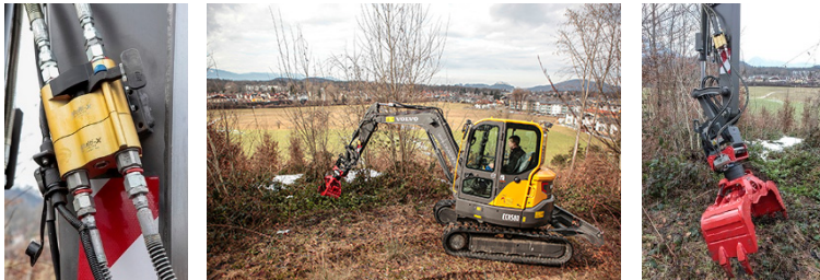
Die Hydraulikschnellkupplung Multi-X erleichtert das Wechseln von Anbauwerkzeugen enorm
